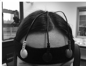
Fig. 9 - Sensore per la misurazione del parametro elettromiografico per la contrazione dei muscoli corrugatori
