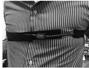
Fig. 8 - Sensore piezoelettrico utilizzato per la misurazione del parametro respiratorio
